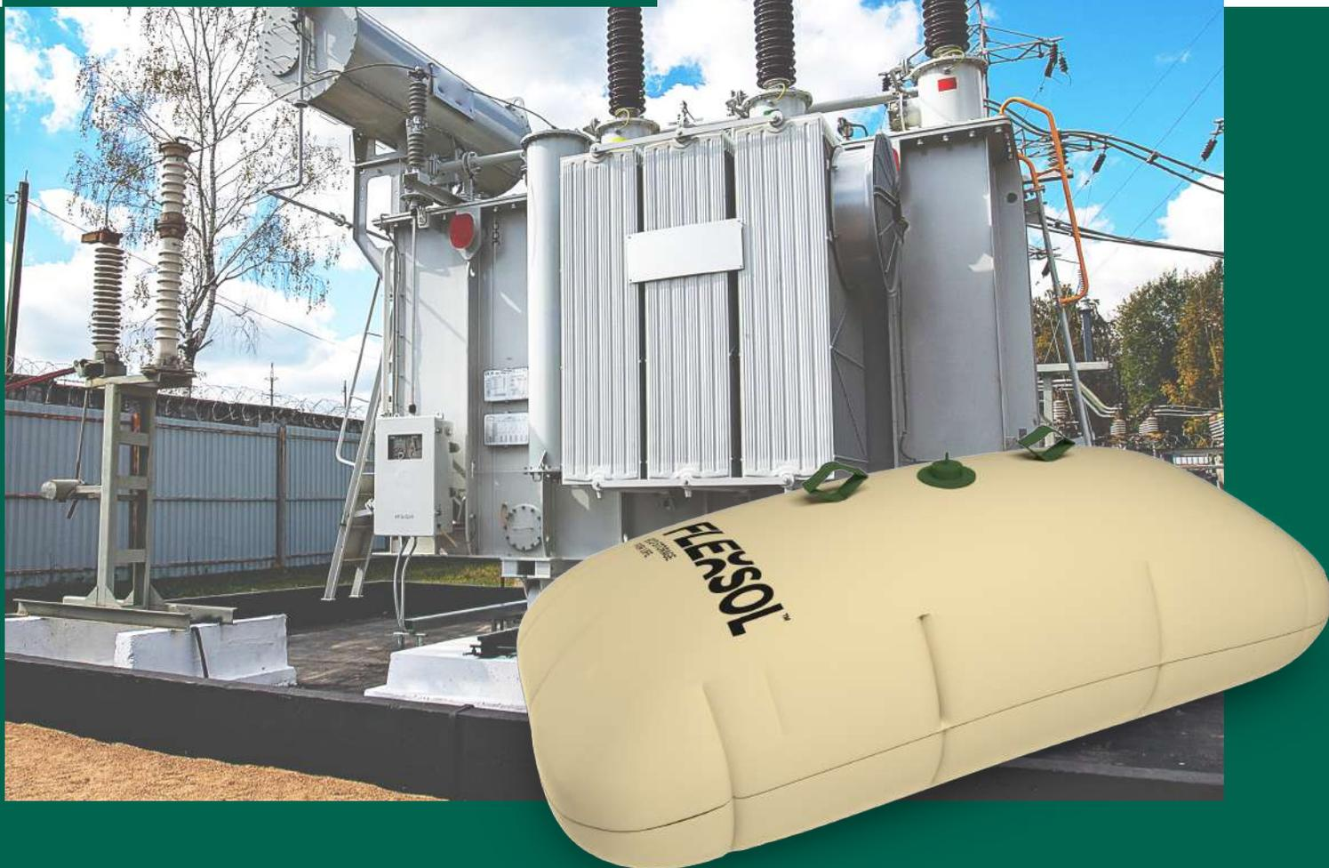
Устанавливаются внутри бака расширителя для защиты масла в трансформаторе и компенсации колебаний его объема при эксплуатации. За счет сокращения площади соприкосновения поверхности масла с воздухом предотвращается окисление и попадание влаги.
